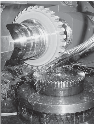
PowerTRUE™正交齿轮的 CNC加工
