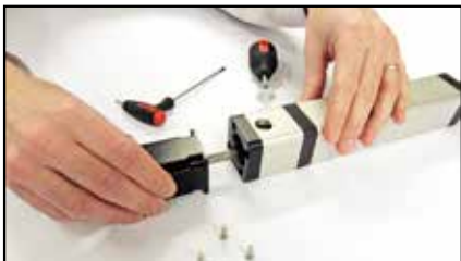
将电机轴插入联轴器内
