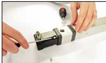
拧紧电机安装螺钉
