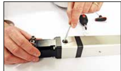
拧紧电机联轴器螺钉并安装密封塞
